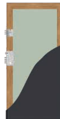
Wypełnienie skrzydła specjalnym wkładem Defender z niepalnej wełny mineralnej z przekładkami akustycznymi
